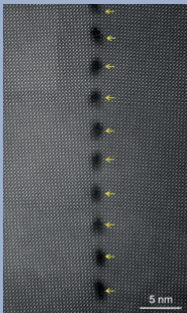
Abb. 6 Eine Kleinwinkelkippkorngrenze in Strontiumtitanat, aufgenommen (entlang einer kristallographischen [001]-Richtung) im STEM im HAADF-Kontrast. Das Intensitätssignal stammt von Elektronen, die um besonders große Winkel gestreut worden sind. Es ist etwa proportional zum Quadrat der Kernladungszahl Z . Damit lassen sich die Strontiumatome ( Z = 38 ) durch ihre höhere Intensität direkt von den Titanatomen ( Z = 22 ) unterscheiden. Die Sauerstoffatome sind nicht sichtbar. Die dunklen Zonen um die Versetzungen (Pfeile) zeigen das elastische Verzerrungsfeld an. [H. DU]
