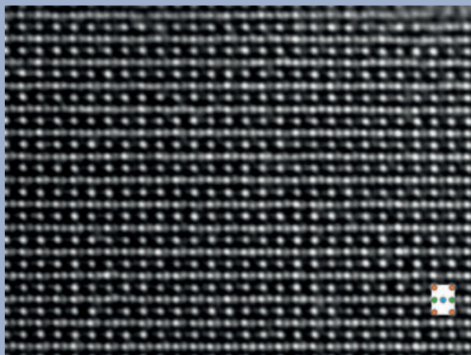
Abb. 1 Abbildung der atomaren Struktur (entlang einer kristallographischen [011]-Richtung) von Strontiumtitanat, \text{SrTiO}_3 , im CTEM mithilfe des NCSI-Kontrastmodus. Die Atompositionen erscheinen hell auf dunklem Grund. Jede dieser Positionen bezeichnet das Bild einer Atomsäule, die so zum einfallenden Elektronenstrahl orientiert ist, dass man die Säule genau von oben sieht. Die Atome der Säule stehen daher genau hintereinander. Die chemische Natur der Atome lässt sich mithilfe der quantitativen Intensitätsberechnung bestimmen. Schema der Atomanordnung: Sr – rot, Ti – grün, O – blau. Horizontaler Abstand zweier Strontiumatome: 3,9 Å. [C. L. JIA]
