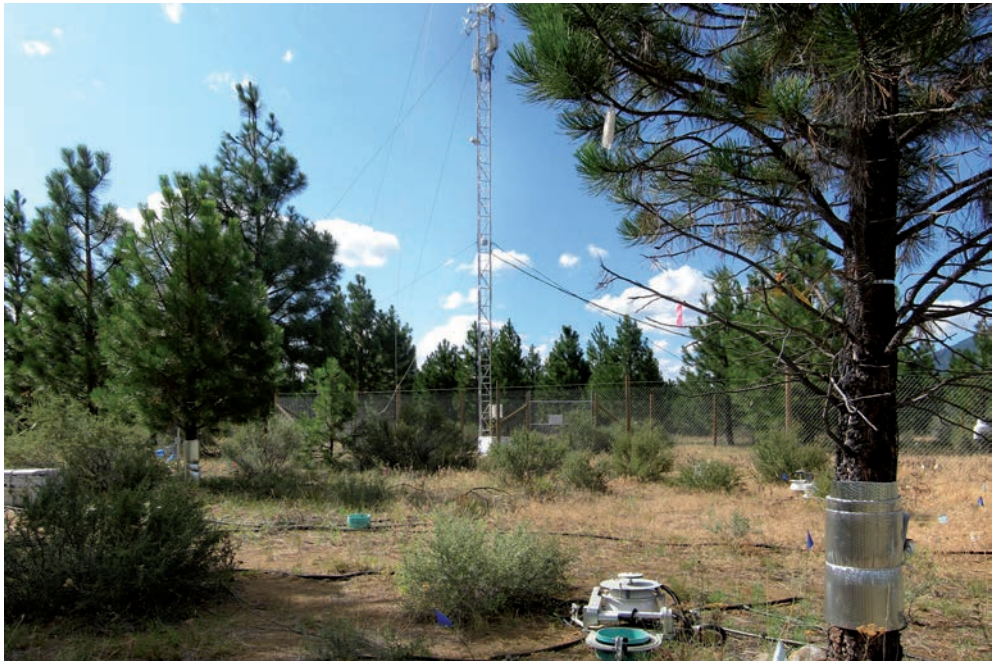
Abb. 1 Das Untersuchungsgebiet, ein junger Pinienwald im Osten Oregons mit Messturm für den H_2O - und CO_2 -Austausch des Waldes sowie zur Bestimmung meteorologischer Variablen. Im Vordergrund ist ein Instrument zur CO_2 -Flussmessung (Respiration) des Bodens zu sehen. Der Baumstamm ist isoliert, um die temperaturempfindliche Wasserflussmessung im Baumxylem (= Transpiration) nicht zu stören.
