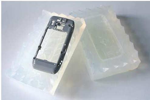
Abbildung 3-12: Silikongussform für ein mit SLA™ hergestelltes Handygehäuse (Quelle: rpprototype.com)
