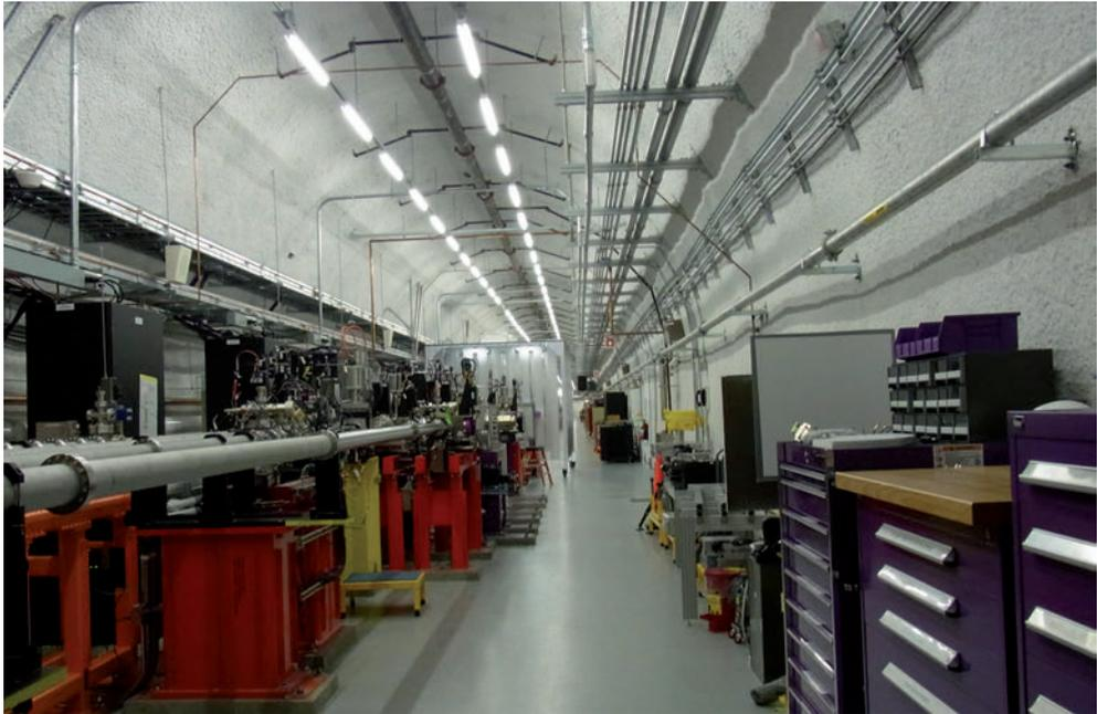
Im SLAC *National Accelerator Laboratory* in Menlo Park, Kalifornien (USA): Blick in den Haupttunnel der *Linac Coherent Light Source* (LCLS), in dem Experimente vorbereitet und eingebaut werden. Anschließend werden mit Hilfe eines hochfrequenten Laserstrahls Röntgenstrahlen erzeugt, um Materialeigenschaften, Strukturen sowie das Verhalten von Molekülen zu erforschen [Foto: Andreas CLAUSING].
