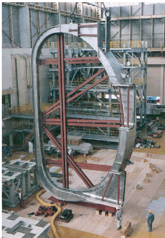
Abb. 8 Darstellung zweier Sektoren des Prototypvakuumgefäßes für ITER, die bereits gefertigt und erfolgreich verschweißt wurden.
