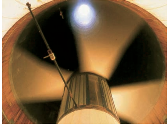
Abb. 12 Turbine der Prototypanlage in Manzanares
